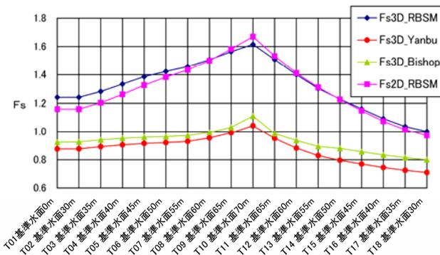
図9 基準水位面の変化ごとの各種安定解析の安全率変化
