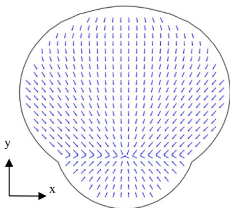
図8 ケースT15(下降時, 基準水位 45m)時, xy面上変位ベクトル
