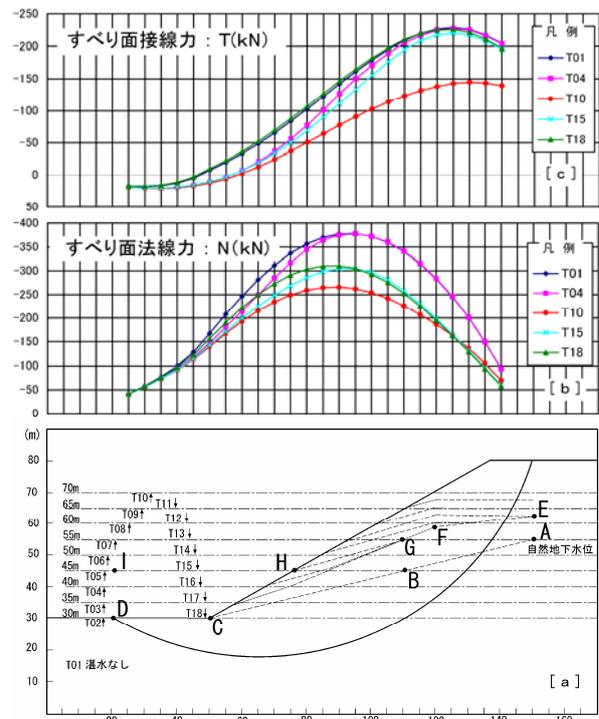
図6 中心断面図における解析ケースとすべり面接線力(T)と法線力(N)の関係
